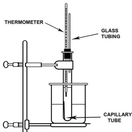
Boiling point apparatus
